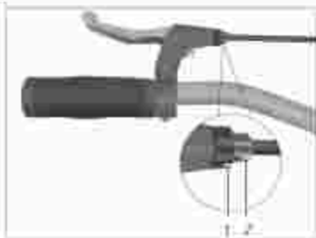
Abb.: Position Kontermutter und Rändelschraube (Beispielwahl)
