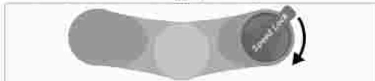
Abb.: Lock-Out-Bedienung auf der Federgabel (Drehknopf gegen den Uhrzeigersinn)
