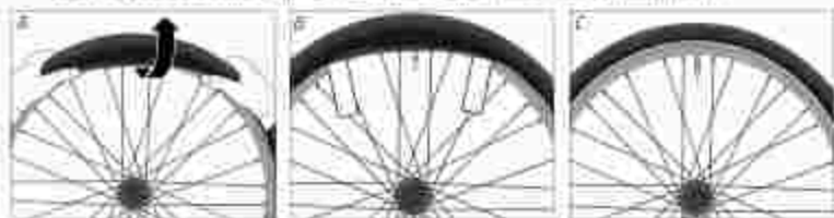
Abh. Draht- oder Faltscheifen montieren (Beispiel)
