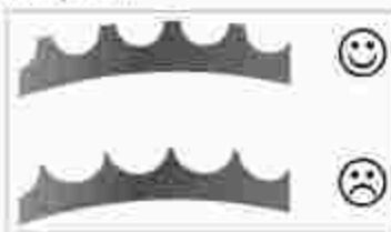
Abb.: Kettenblattverschleiß (vergrößert)
