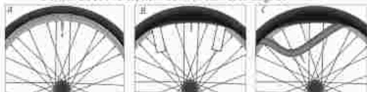
Abb.: Draht- oder Falzreifen demontieren (weiterleitet)
