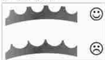
Rys. Zużycie przedniej zębaki (przykład)
