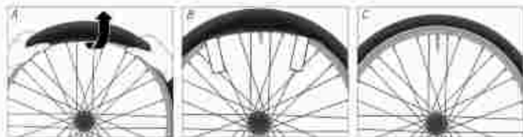
51. Montaža ščevnih ali nogulčnih pnevmatik (za poltogo promet)
