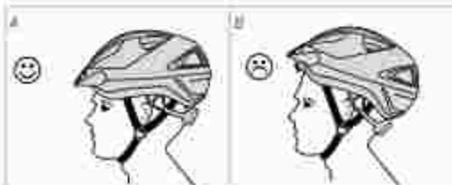
Si. Prilenje čelade (a) pravično, (b) je preveč nagnjeno (na podlagi pramenit)
