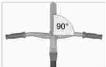
Slika: Pravilna izravnava zornika žra potilagi prihrniti
