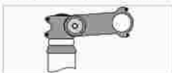
Sl. Stranski vijak na sprednjem delu volana (na podlagi primera)
