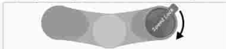
34. Upravljanje funkcije Lock-Out na vzmetnih vilicah (pogled od zgoraj, na podlagi primera)
