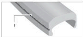
Ill.: Fælg med slidindikator (eksempel) 1 Fordybning
