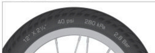
III: Dæk med oplysning af dækstørrelsen (eksempel)
