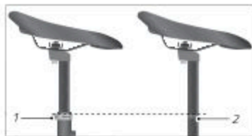
Ill.: Sadelpindens min.indstiksdybde (eksempel)
