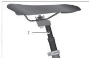
III.: Glideflade affjedret sadelpind (eksempel)
