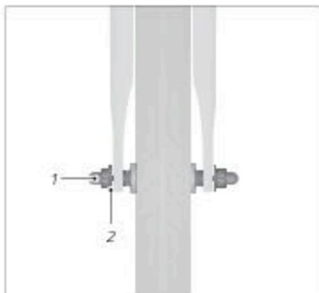
III: Hjul med skrueaksel (eksempel)
