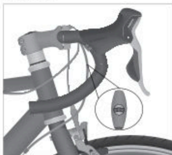
Øl: Indstil kædegearet (eksempel) Indstillingsskrue med justeringshjul til trækspændingen
