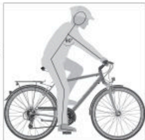
III: Optimal sadelhøjde (eksempel)
