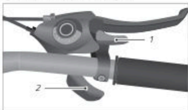
III: Betjeningsenhed på styret til skift af tandhjulene og klingerne (her som eksempel på højre styrt)
