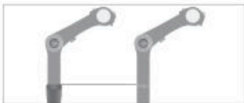
III.: Markeringen af min.indstiktsdybden ved en skaftfrempind med indvendig klemning (eksempel)
