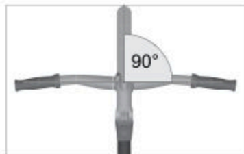
Ill.: Korrekt styrjustering (eksempel)
