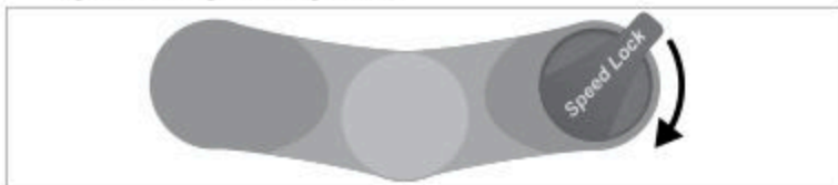
III: Lock-out-betjening på fjedergaflen (set ovenfra, eksempel).
