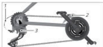
Ill.: Komponenter af et kædegear (eksempel)
