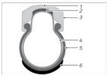
Ill.: Hjultværsnit med dæk (eksempel)
