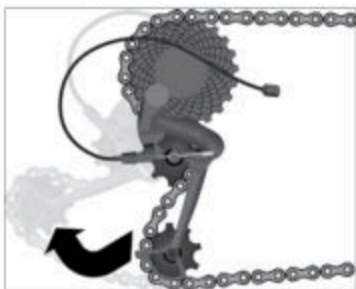
III.: Træk bagskifteren bagud (eksempel)
