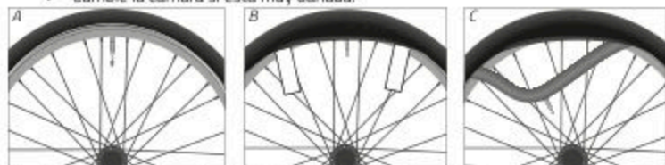
Fig.: Desmontaje de los neumáticos radiales (ejemplo)
