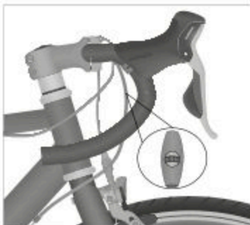
Fig.: Ajuste del cambio de cadena (ejemplo) Tornillo de ajuste con rueda de ajuste para la tensión del cable
