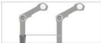
Fig: Marca de la profundidad de inserción mínima en una potencia de vástago con fijación interna (ejemplo)
