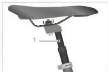
Fig.: Superficie de deslizamiento de la tija con suspensión (ejemplo)
