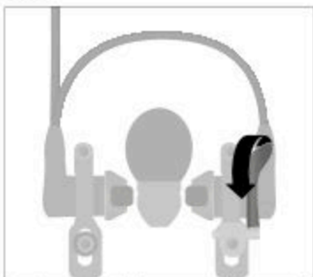
Fig.: Preparación del freno en caso de frenos de llanta hidráulicos (ejemplo)
