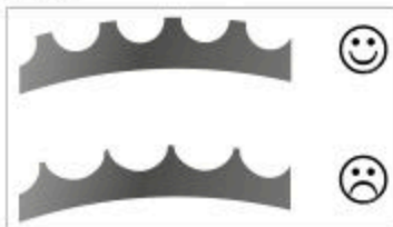
Fig.: Desgaste del plato (ejemplo)
