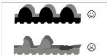
Fig.: Desgaste de la correa (ejemplo)
