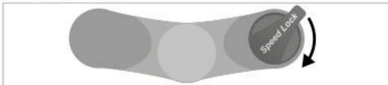
Fig.: Manejo de la función Lock-Out en la horquilla de suspensión (vista desde arriba, ejemplo).
