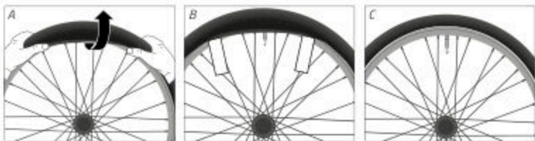
Fig.: Montaje de los neumáticos radiales (ejemplo)
