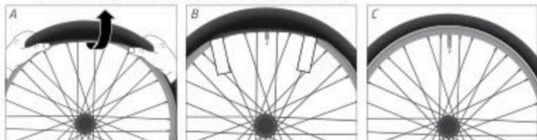
Kuva: Vajjerillisen tai taittorenkkaan asennus (esimerkki)
