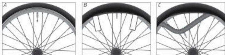
Kuva: Vajjerillisen tai taittorenkaan irrotus (esimerkki)
