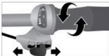
Kuva: Yhdistetty kierto- ja vaihdevipukytkin Dual Drive (esimerkki)
