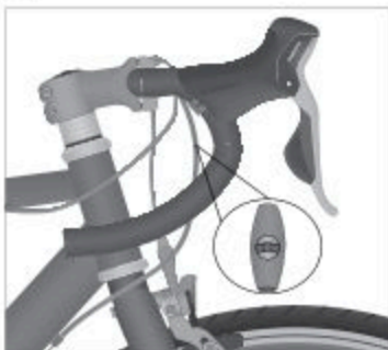
Kuva: Ketjuvaihteiston säätö (esimerkki) Säätöruuvi säätöpyörällä vajerin kireyttä varten
