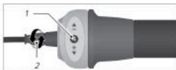
Kuva: Säätöruuvi kiertokahvassa (esimerkki)
