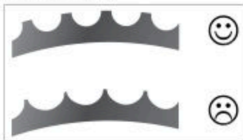
Kuva: Eturattaan kuluma (esimerkki)
