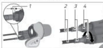
Kuva: Vaihdenvaijerikotelon (vas.) välys ja säätöruuvi (oik.) (esimerkki)
