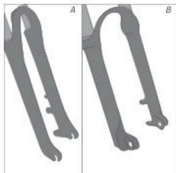
Kuva: Avoimet (A) ja suljetut (B) haarukanpäät (esimerkki)
