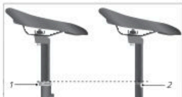
Kuva: Istuinkannattimen vähimmäispistosyvyys (esimerkki)
