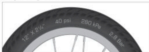
Kuva: Rengas ja rengaskoon tiedot (esimerkki)
