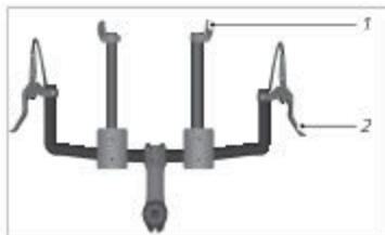
Kuva: Vaihdevipujen ja jarrukahvojen välinen etäisyys aero-ohjaustangossa (esimerkki)
