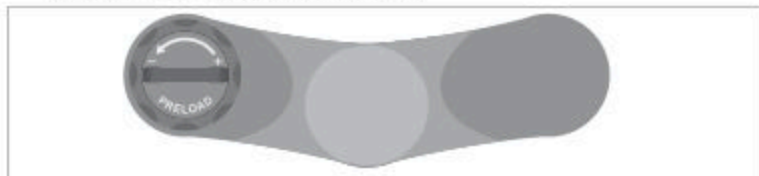
Kuva: Säädin joustoetuhaarukalla (ylhäältä katsottuna, esimerkki).
