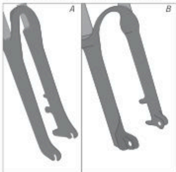
Fig. : Pattes de fixation ouvertes (A) ou fermées (B) (exemple)
