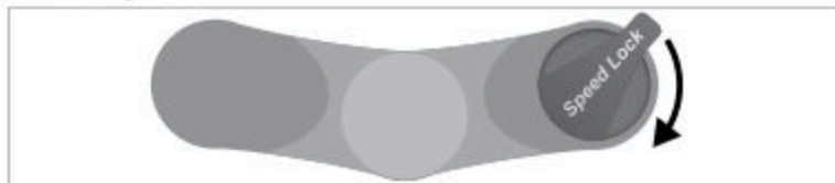
Fig. : Commande du lockout sur la fourche suspendue (vue plongeante, exemple).
