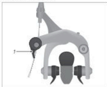
Fig. : Préparer les freins de vélos de route (exemple)
