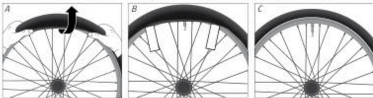
Fig. : Monter un pneu à tringles rigides ou souples (exemple)
