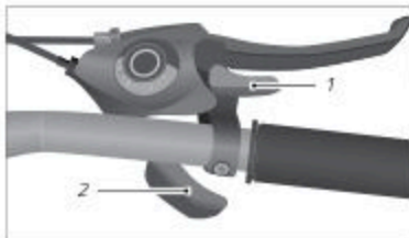
Fig. : Unité de commande située sur le cintre pour engager la chaîne sur les pignons et les plateaux (ici, par exemple, sur le cintre de droite)
