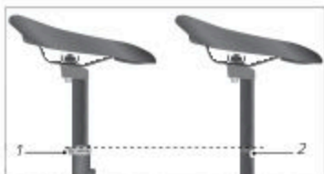
Fig. : Profondeur d'insertion minimale de la tige de selle (exemple)
