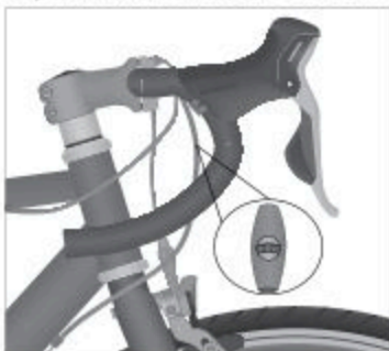
Fig. : Régler le dérailleur (transmission par chaîne) (exemple), barillet avec molette de réglage pour la tension de câble
