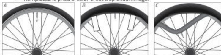
Fig. : Démontez un pneu à tringles rigides ou souples (exemple)
