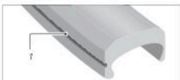
Fig. : Jante avec indicateur d'usure (exemple)
