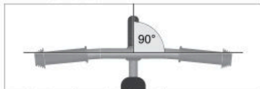
Fig. : Orientation adéquate du cintre (exemple)
