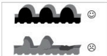
Fig. : Usure de la courroie (exemple)
