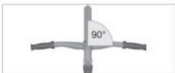
Fig. : Orientation adéquate du cintre (exemple)
