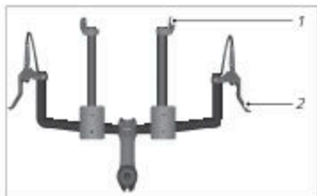
Fig. : Distance entre manettes de vitesse et leviers de frein sur aérobasse (exemple)
