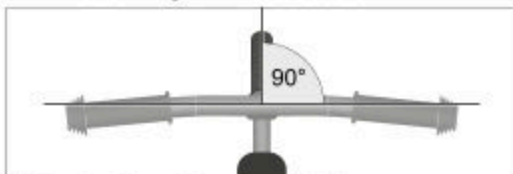
Abb.: Korrekte Lenkerausrichtung (exemplarisch)
