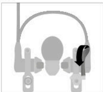
Abb.: Bremse vorbereiten bei hydraulischen Felgenbremsen (exemplarisch)
