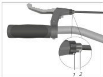
Abb.: Position Kontermutter und Rändelschraube (exemplarisch)
