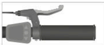
Abb.: Position der Fernsteuerung (exemplarisch)
