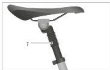
Abb: Gefederte Sattelstütze (exemplarisch) 1 Federung innenlegend
