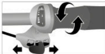
Abb.: Kombiniertes Drehgriff- und Schalthebelschalter Dual Drive (exemplarisch)
