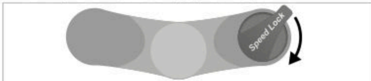
Abb.: Lock-Out-Bedienung auf der Federgabel (Draufsicht, exemplarisch).
