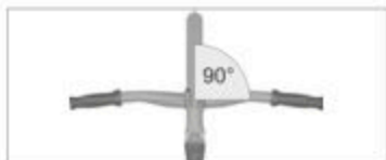
Abb.: Korrekte Lenkerausrichtung (exemplarisch)
