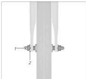
Abb.: Laufrad mit Schraubachse (exemplarisch)
