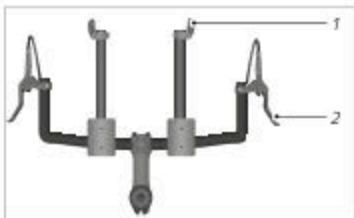
Abb.: Abstand zwischen Schalthebeln und Bremshebeln beim Aero-Lenker (exemplarisch)
