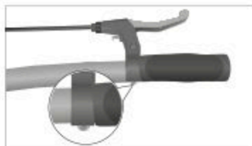
Abb.: Position der Bremshebel (exemplarisch)
