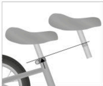
Abb.: Markierung Sattelstütze (exemplarisch)
