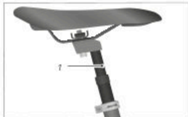
Abb.: Gleitfläche gefederte Sattelstütze (exemplarisch)
