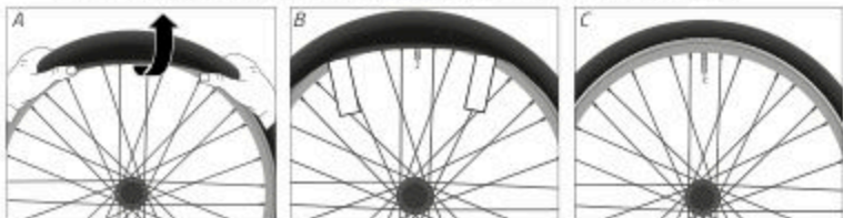
Abb.: Draht- oder Faltringe montieren (exemplarisch)
