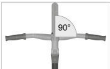
Abb.: Korrekte Lenkerausrichtung (exemplarisch)
