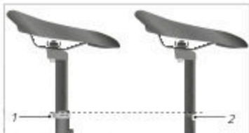
Abb.: Mindesteinstecktiefe der Sattelstütze (exemplarisch)
