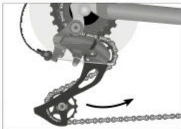
Abb.: Kettenspanner an dem Hinterrad (exemplarisch)
