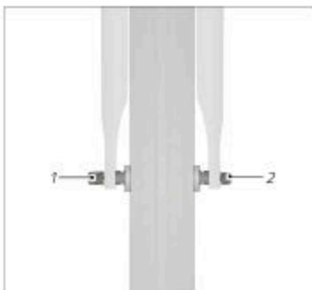
Abb.: Laufrad mit Steckachse (exemplarisch)
