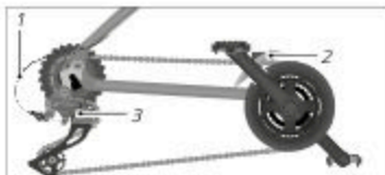
Abb.: Komponenten einer Kettenschaltung (exemplarisch)
