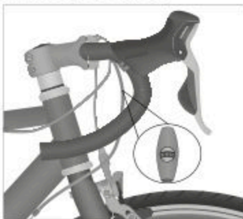
Abb.: Kettenschaltung einstellen (exemplarisch) Einstellschraube mit Verstellrad für die Zugspannung
