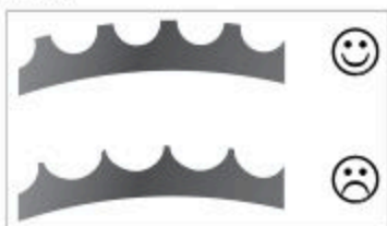
Fig: Usura della corona (esempio)
