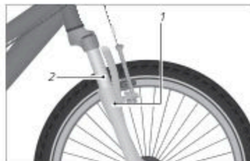
Fig. Forcella ammortizzata (esempio)
