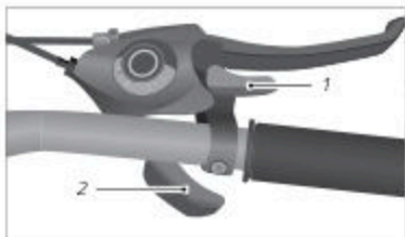
Fig.: Unità di comando sul manubrio per l'innesto di pignoni e corone (esempio del lato destro del manubrio)
