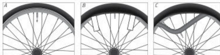
Fig.: Smantaggio pneumatici rigidi o pieghevoli (esempio)
