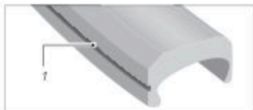
Fig.: Cerchio con indicatore di usura (esempio) 1 Scanalatura
