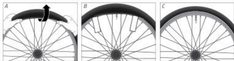
Fig.: Montaggio pneumatici rigidi o pieghevoli (esempio)
