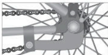
Fig.: Freno a contropedale (esempio)
