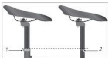
Fig.: Profondità minima di inserimento del reggisella (esempio)
