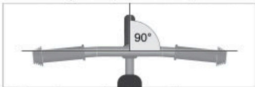
Fig.: Corretto orientamento del manubrio (esempio)
