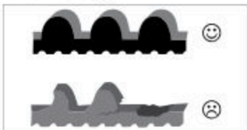
Fig.: Usura della cinghia (esempio)
