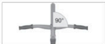
Fig. Corretto orientamento del manubrio (esempio)
