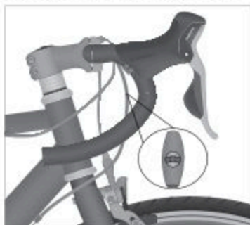
Fig. - Regolazione del deragliatore esterno (esempio) Vite di regolazione con rotellina per regolare la tensione del cavo
