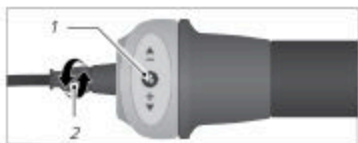
Fig.: Vite di regolazione su manopola del cambio (esempio)
