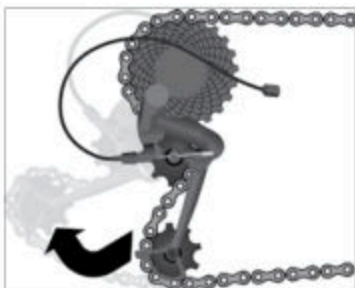
Fig.: Spostamento all'indietro del deragliatore posteriore (esempio)
