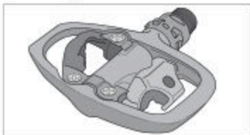
Fig.: Pedale automatico (esempio)
