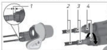
Fig: Gioco della guaina del cavo (sin.) e vite di regolazione (dx.) (esempio)
