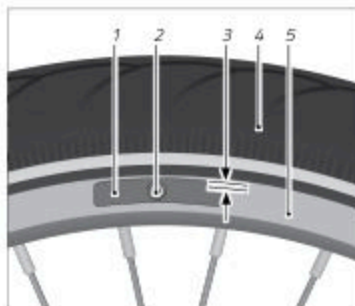
Fig. Orientamento pattino del freno (esempio)
