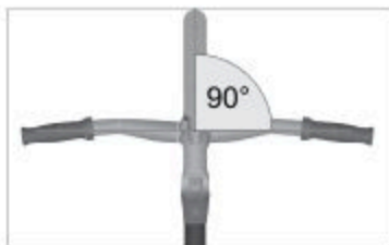
Fig.: Corretto orientamento del manubrio (esempio)
