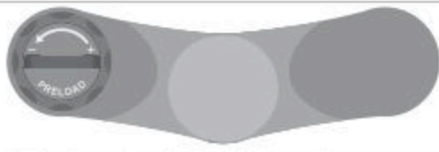
Fig.: Manopola sulla forcella ammortizzata (veduta dall'alto, esempio).
