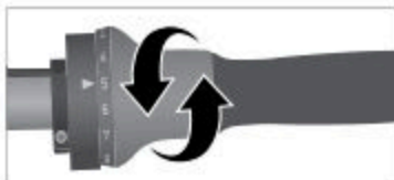
Fig.: Manopola del cambio (esempio)
