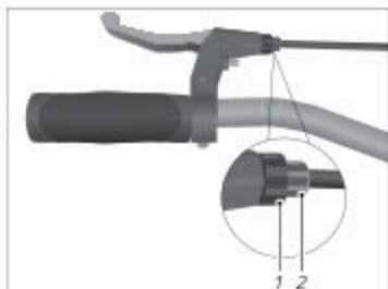
Fig.: Posizione controdado e vite zigrinata (esempio)
