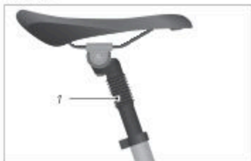
Fig.: Reggisella ammortizzato (esempio)
