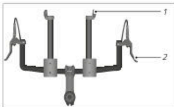
Rys.: Odstęp między manetkami a dźwigniami hamulcowymi w przypadku kierownicy Aero (przykład)
