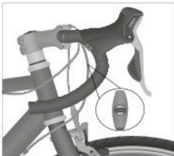
Rys.: Ustawianie przerzutki zewnętrznej (przykład) Śruba nastawcza z kołem regulacyjnym do naprężania linki
