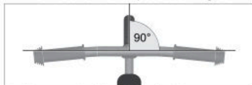
Fig.: Orientarea corectă a ghidonului (exemplificativ)
