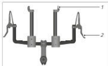
Fig. Distanța dintre maneta de comutare și maneta de frână la ghidoanele Aero (exemplificativ)
