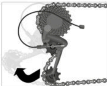
Fig.: Trageți spre înapoi sistemul de schimbare a treptelor de viteză (exemplificativ)
