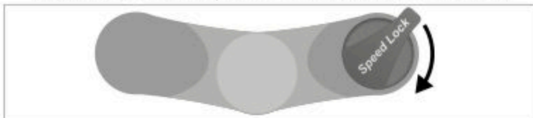
Fig.: Operarea funcției lock-out de pe furca elastică (vedere de sus, exemplificativ)
