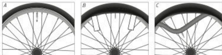
Fig.: Demontarea anvelopelor cu talon din sârmă și a anvelopelor pliabile (exemplificativ)
