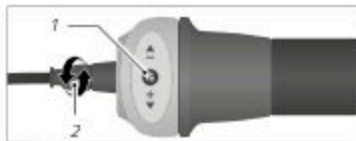
Fig.: Șurubul de reglaj de pe comutatorul cu mâner rotativ (exemplificativ)
