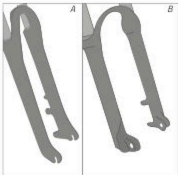
Fig.: Capete de reținere deschise (A) și închise (B) (exemplificativ)
