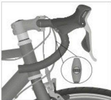
Fig: Reglarea deraiorului (exemplificativ) Șurub de reglaj cu roată de reglaj pentru tensionarea timoneriei
