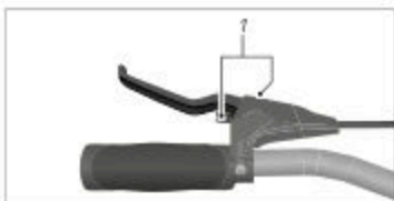
Fig.: Poziția șurubului de reglaj (exemplificativ)
