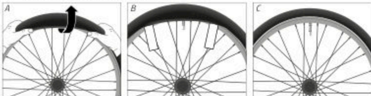
Fig: Montarea anvelopelor cu talon din sârmă și a anvelopelor pliabile (exemplificativ)
