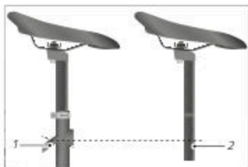
Fig.: Adâncimea minimă de introducere a suportului șeii (exemplificativ)
