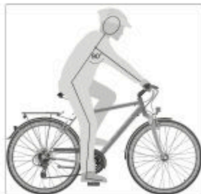
Fig. -optimală înălțimea optimă a șeii (cu titlu de exemplu)
