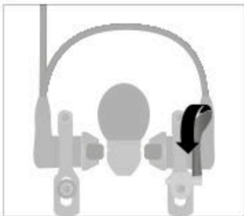
Fig.: Pregătirea frânelor în cazul frânelor hidraulice pe jantă (exemplificativ)
