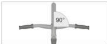
Fig.: Orientarea corectă a ghidonului (exemplificativ)
