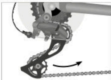
Fig.: Întinzătorul de lanț pe roata din spate (exemplificativ)
