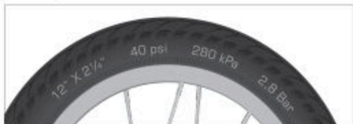
Fig.: Anvelopă cu specificarea dimensiunii anvelopei (exemplificativ)
