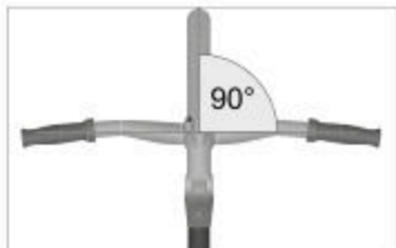
Fig.: Orientarea corectă a ghidonului (exemplificativ)
