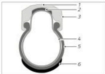
Fig.: Secțiune transversală a roții cu anvelopă (exemplificativ)
