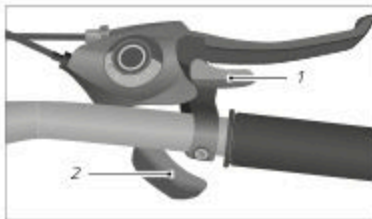
Fig.: Unitatea de operare de pe ghidon pentru comutarea pinioanelor și foilor de angrenaj (aici, exemplificativ la un ghidon drept)
