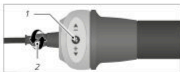
Sl: Nastavitveni vijak na stikalu na vrtljivem ročaju (na podlagi primera)
