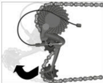
Sl.: Povlek prestavnega mehanizma nazaj (na podlagi primera)
