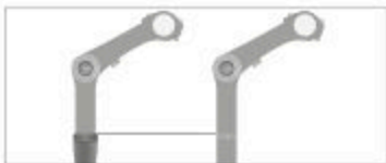
Sl.: Oznaka najmanjše vstavne globine pri sprednjem delu telesa z notranjo pritrditvijo (na podlagi primera)
