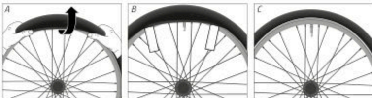
Sl: Montaža žičnatih ali nagubanih plaščev (na podlagi primera)
