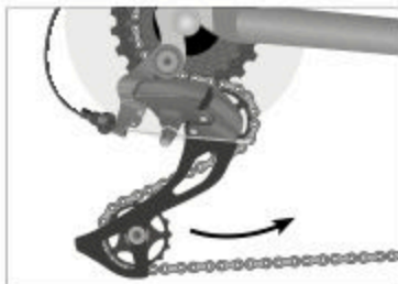
Sl.: Napenjalnik verige na zadnjem kolesu (na podlagi primera)
