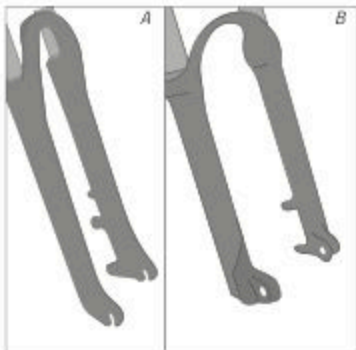
Sl.: Odprti (A) in zaprti (B) nastavki (na podlagi primera)
