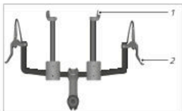
Sl: Razdalja med prestavnimi in zavornimi ročicami pri aerodinamičnem volanu (na podlagi primera)
