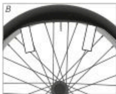
Sl: Demontaža žičnatih ali nagubanih plaščev (na podlagi primera)
