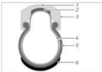
Slika: Presek kolesa s plaščem (na podlagi primera)
