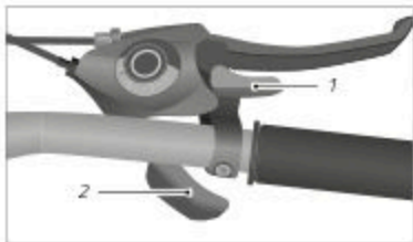
Slika: Upravljalna enota na volanu za preklapljanje pastarkov in verižnih listov (tukaj na podlagi primera na desnem volanu)
