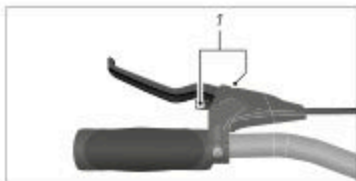
Sl: Položaj nastavitvenega vijaka (na podlagi primera)
