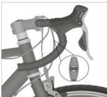
Sl: Nastavitvev verižnega menjalnika (na podlagi primera) Nastavitveni vijak z nastavitvenim kolescem za natezno napetost
