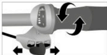
Sl: Kombinirano stikalo na vrtljivem ročaju in prestavni ročici Dual Drive (na podlagi primera)
