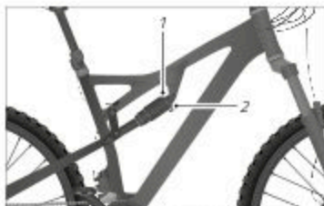
Sl: Vzmetenje zadnjega dela vozila (na podlagi primera)
