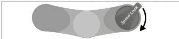
Sl.: Upravljanje funkcije Lock-Out na vzmetnih vilicah (pogled od zgoraj, na podlagi primera).
