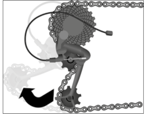
Abb.: Schaltwerk nach hinten ziehen (exemplarisch)
