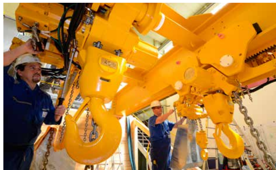
Samarbeidet med egne leverandører i verdensklasse er en viktig del av suksessen til Westcon Løfteteknikk. Her kontrollerer spesialister fra J.D. Neuhaus i Tyskland i kranen som Westcon Løfteteknikk konstruerte for Scarabeo 8. Det var den største kranen J.D.Neuhaus hadde levert.
