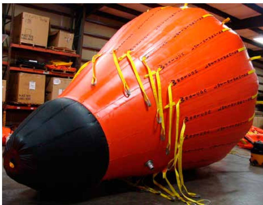
Et av utleieproduktene det er stor etterspørsel etter er vannballonger som kan brukes som vekter. Suksessproduktet er lett å transportere og lagre når det er tomt. Denne ballongen veier 35 tonn når den er fylt med vann.
