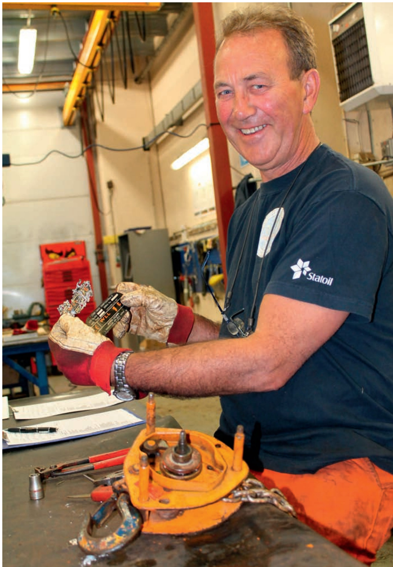
Geir Monstad i ferd med å overhale ei talje som kunden har brukt under vann. Det gamle skiltet er en påminnelse til båteiere om hvordan det kan gå om man ikke passer på offeranodene. Monstad forsikrer oss om at denne talja kommer til å bli som ny igjen.
