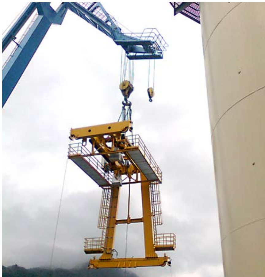
Kranen for håndtering av juletreet som Westcon Løfteteknikk har levert til "Scarabeo 8" er i ferd med å bli løftet om bord på riggen i Ølensvåg.
