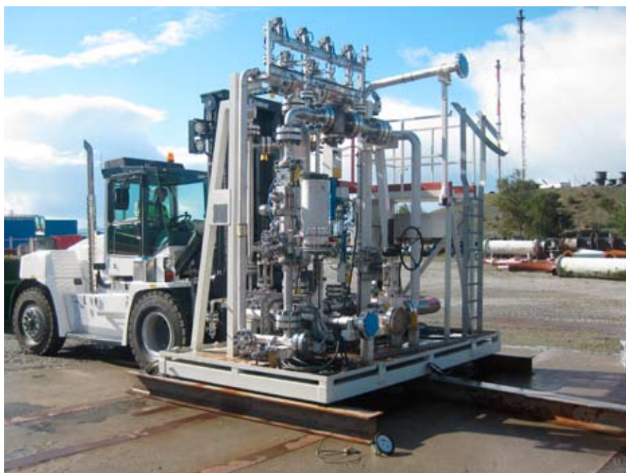
WCL foretar veiing av en ISO Unit hos Statoil (K-lab) på Kårstø. Veiingen gjøres for å bestemme eksakt vekt, og finne tyngdepunktet. Det siste er viktig for å vite hvordan løfteredskapene skal plasseres for at enheten skal holde seg i vater under løfteoperasjonen.
