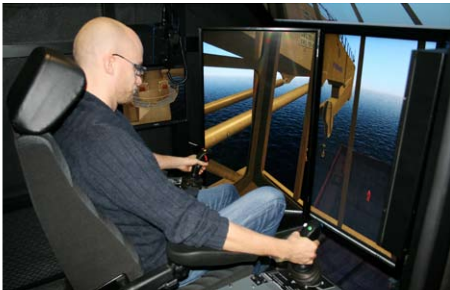
Den nye simulatoren som skal benyttes på kranførerkursene gir anledning til å trene løfting under svært realistiske forhold. Her tester Martin Grainge fra leverandøren Kongsberg Maritim offshore-kransimulatoren.
