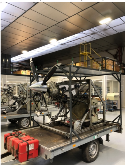
Figure 9 : Moteur monté sur le banc d'essai
