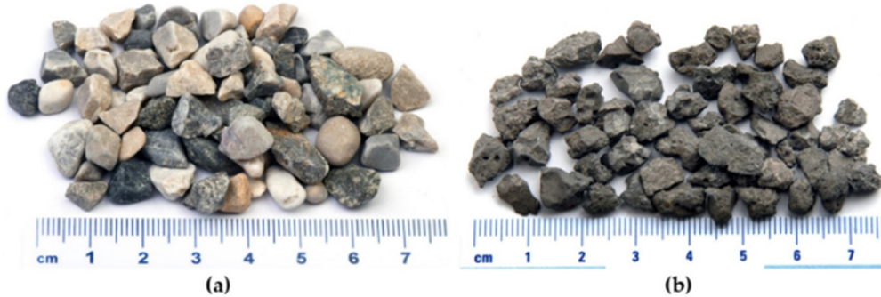
Abbildung 15: a) natürliches Aggregat und b) Stahlschlackenaggregat für Lichtbogenöfen (Electric Arc Furnace (EAF) steel slag aggregate)
