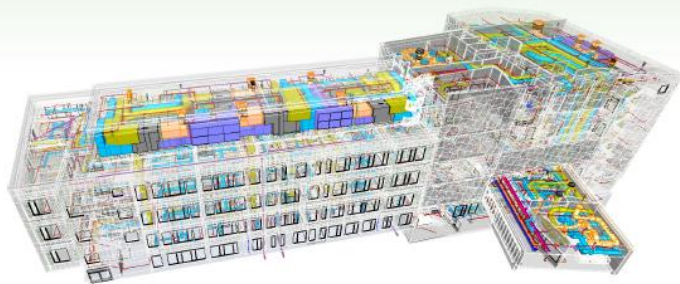
Bildet viser VVS-anlegget i BIM-modellen til Voldslekka skole
