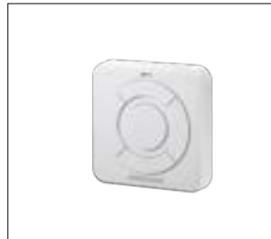
Funk-Innentaster FIT 5 BS 4 Tastenfunktionen plus Abfragetaste für Statusmeldung, Kunststoffgehäuse in Reinweiß RAL 9010
