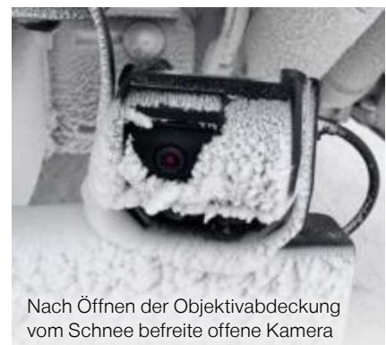
„Augenlid“-Effekt beim Öffnen der Objektivabdeckung
