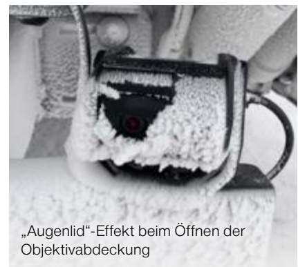
Kamera auch bei Schneefall durch Shuttergehäuse einsatzbereit
