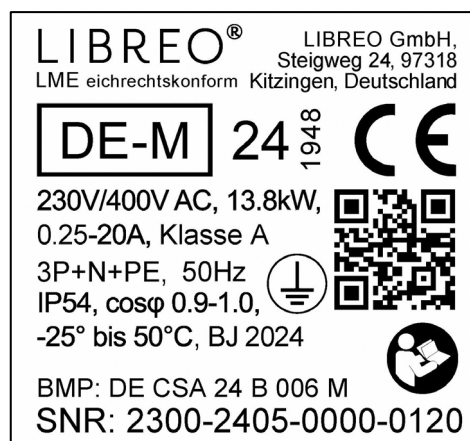
Abbildung 14 weißes Typenschild (eichrechtlich)
