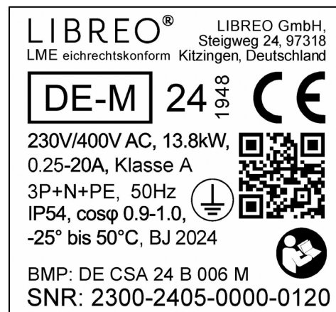
Abbildung 10 weißes Typenschild (eichrechtlich)
