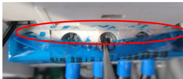
Abbildung 28 VOID-Merkmale nach weggeklappter Sicherung
