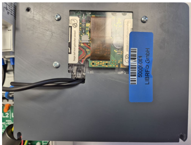
Abbildung 33 Klebesicherung auf der Rückseite der Displayhalterung
