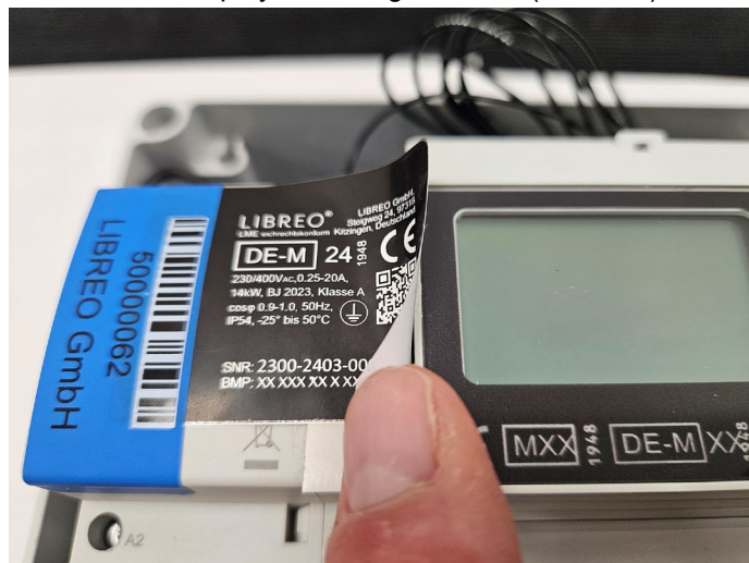
Abbildung 61 Typenschild schwarz recht lösen
