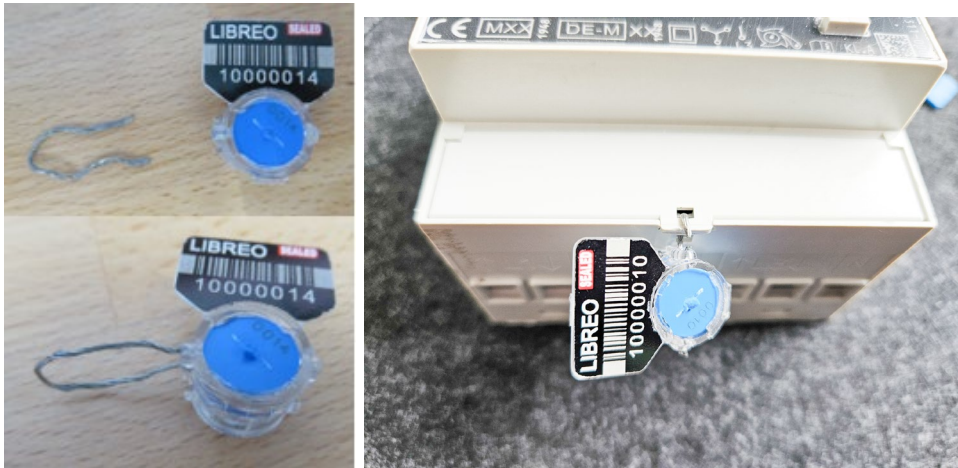
Abbildung 22 lose eingesteckter Draht – rechts durchtrennter Draht
