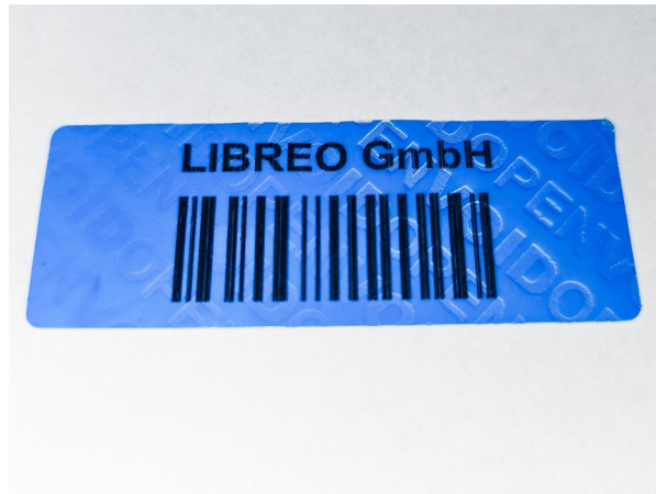
Abbildung 26 VOID-Merkmale nach erneutem Aufkleben
