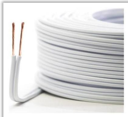
Conductor de cobre blando trenzado flexible. Aislamiento de PVC 60°C. Color Blanco, formado por dos cordones de hilos de cobre suave trenzados en haz, dispuestos en forma paralela, aislados con cloruro de polivinilo (PVC) y unidos por una membrana del mismo material que facilita su separación.
