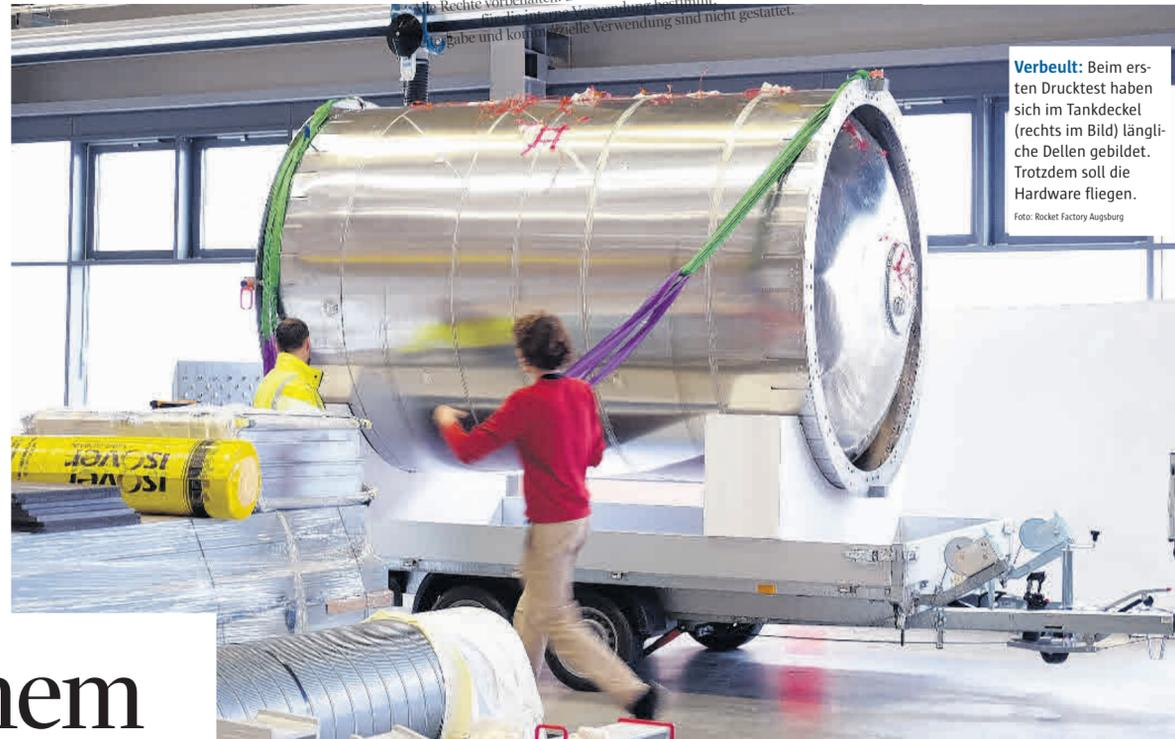
**Verbeult:** Beim ersten Drucktest haben sich im Tankdeckel (rechts im Bild) längliche Dellen gebildet. Trotzdem soll die Hardware fliegen. Foto: Rocket Factory Augsburg
