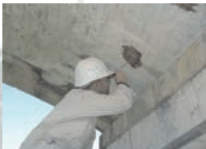
Observação endoscópica do arco duma ponte antiga. Boroscopic observation of the interior of a masonry bridge.
