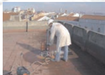
Extracção de carote na laje de cobertura de um edifício, para caracterização do material. Core extraction from building's roof layer in order to characterise the material.
