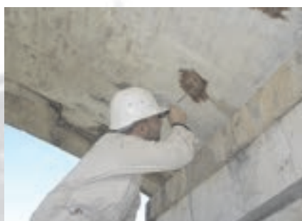
Observação endoscópica do arco duma ponte antiga. Boroscopic observation of the interior of a masonry bridge.
