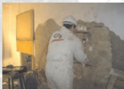
Ensaio de macacos planos numa parede: medição de deslocamentos com alongâmetro. Flatjack tests: measurement of strain.
