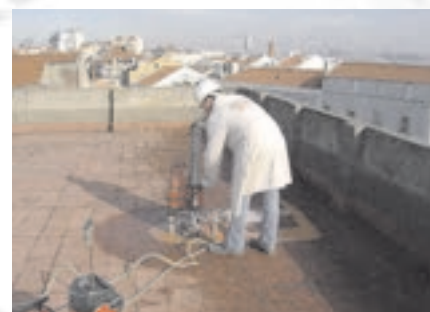
Extracção de carote na laje de cobertura de um edifício, para caracterização do material. Core extraction from building's roof layer in order to characterise the material.
