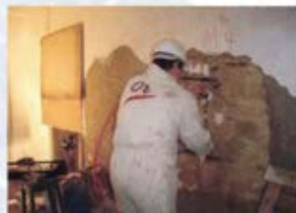
Ensaio de macacos planos numa parede: medição de deslocamentos com alongâmetro. Flat jack tests: measurement of strain.
