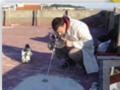
Observação boroscópica da constituição de uma cobertura.
