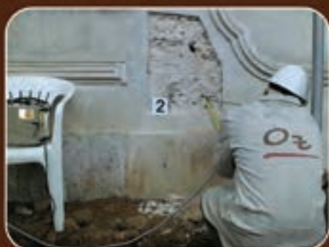
Observação boroscópica de uma parede
