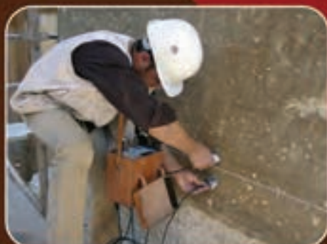
Ensaio de ultra-sons na Ponte Angeja
