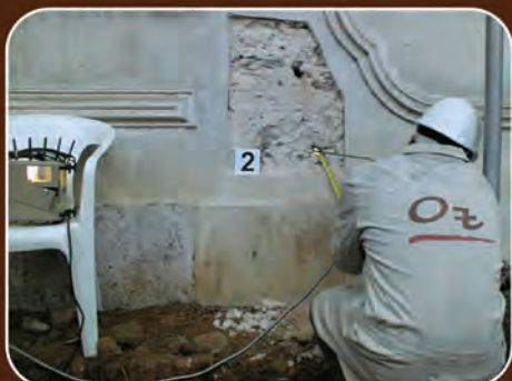
Observação boroscópica de uma parede
