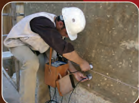
Ensaio de ultra-sons na Ponte Angeja
