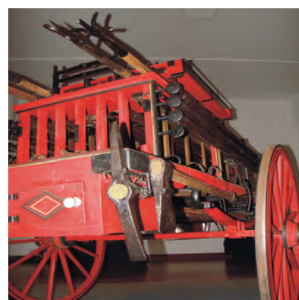
Carro de Material – 1929. Destinava-se a transportar diversas ferramentas para o local de incêndio, como desferradeiras, croques, machados, picaretas, escadas e outros
