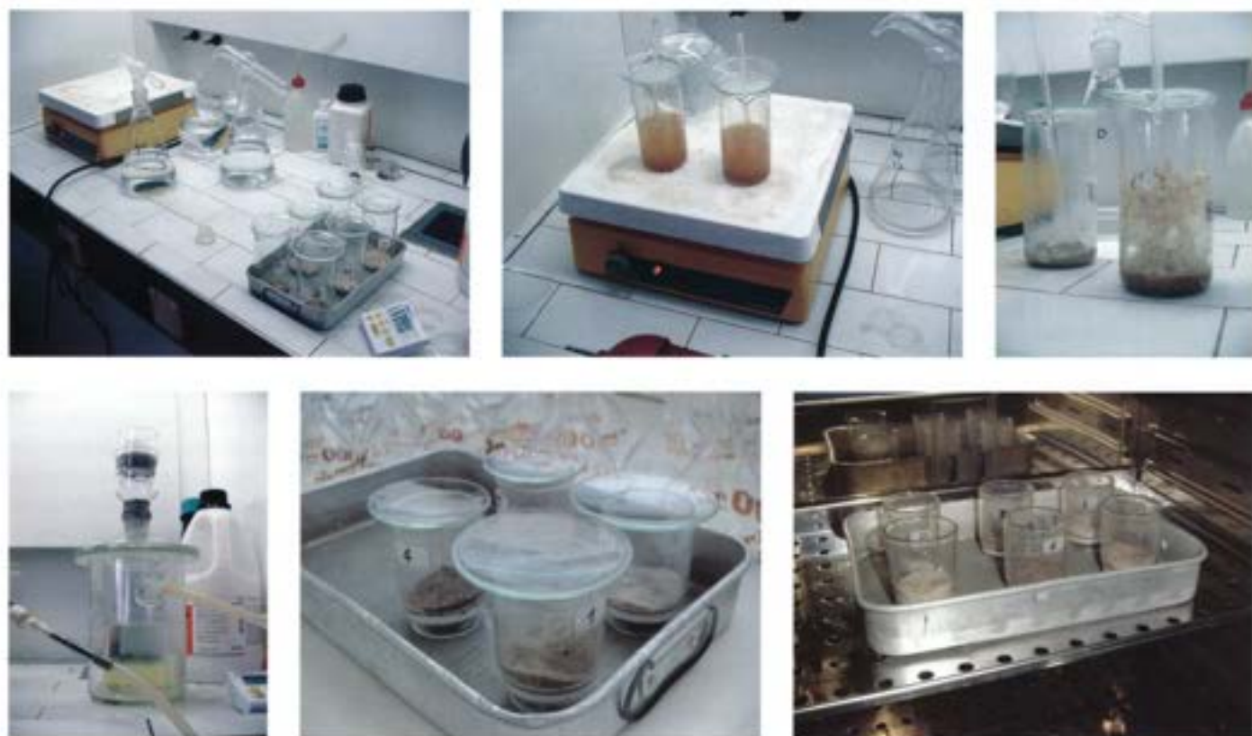
Fig. 2 - Fases principais do processo de ataque e obtenção do resíduo insolúvel (da esquerda para a direita e de cima para baixo): adição de solução de ácido clorídrico; dissolução e sedimentação; recuperação de resíduo insolúvel para o cadinho; decantação por vácuo; secagem de cadinhos contendo o resíduo insolúvel
