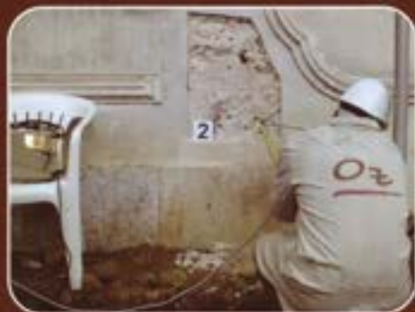
Observação boroscópica de uma parede
