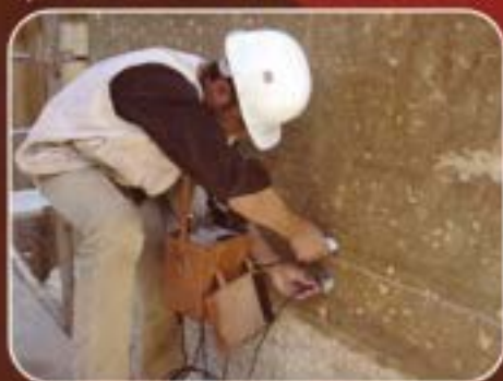
Ensaio de ultra-sons na Ponte Angeja
