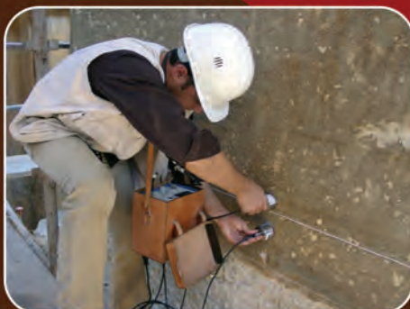
Ensaio de ultra-sons na Ponte Angeja
