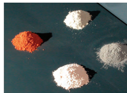
Amostras de pozolanas e ligantes - à esquerda, material de barro vermelho e em baixo, caulino, sujeitos a tratamentos (térmicos e granulométricos); em cima, cal aérea hidratada e à direita, cimento
