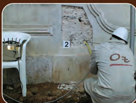
Observação boroscópica de uma parede
