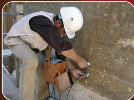
Ensaio de ultra-sons na Ponte Angeja
