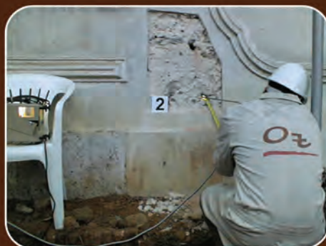
Observação boroscópica de uma parede
