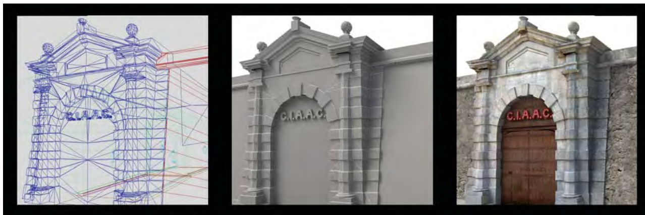
Levantamento Arquitectónico do Forte de Cascais (pormenor da porta principal): modelo tridimensional em ambiente de trabalho – wireframe, imagem do modelo geométrico poligonal, imagem do modelo final texturado com os ortofotos.
