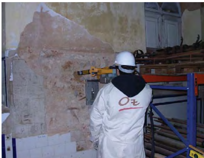
Fig. 3 – Realização do corte numa parede resistente de alvenaria de pedra para a realização de ensaios de macacos planos
