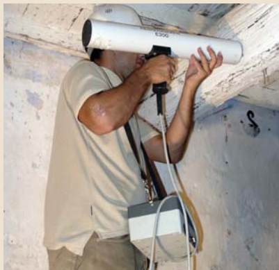
Deteção de alterações no interior de elementos estruturais de madeira por meio de resistografia
