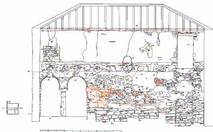
Leitura estratigráfica do alçado correspondente ao corte longitudinal CC'
