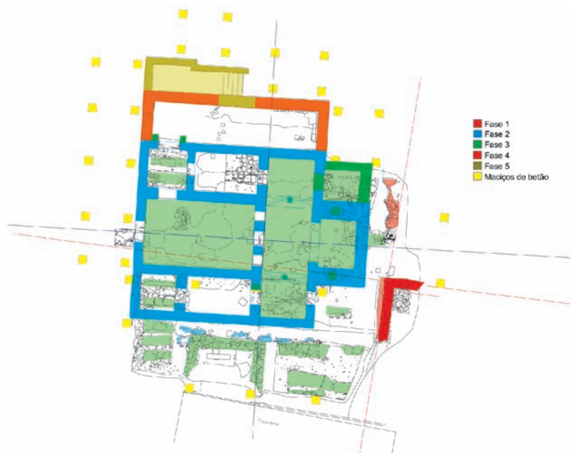
Planta do edifício e ruínas de São Gião da Nazaré, com identificação das principais fases construtivas
