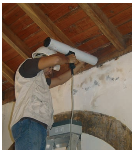
6 - Ensaio de resistografia em freixal
