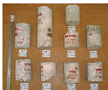
Amostras extraídas para ensaios de avaliação da resistência mecânica
