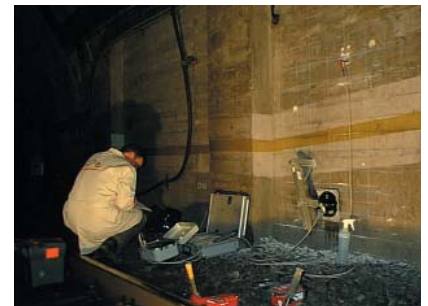
Figura 3 – Medição de intensidade de corrosão e do potencial eléctrico das armaduras numa zona de ensaios localizada na parede lateral no túnel.
