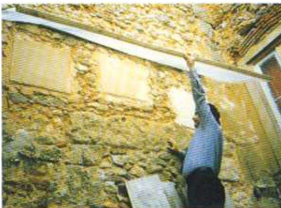
Painéis experimentais de pequena dimensão de reboco de cal executados no contraforte da Torre do Relógio.
