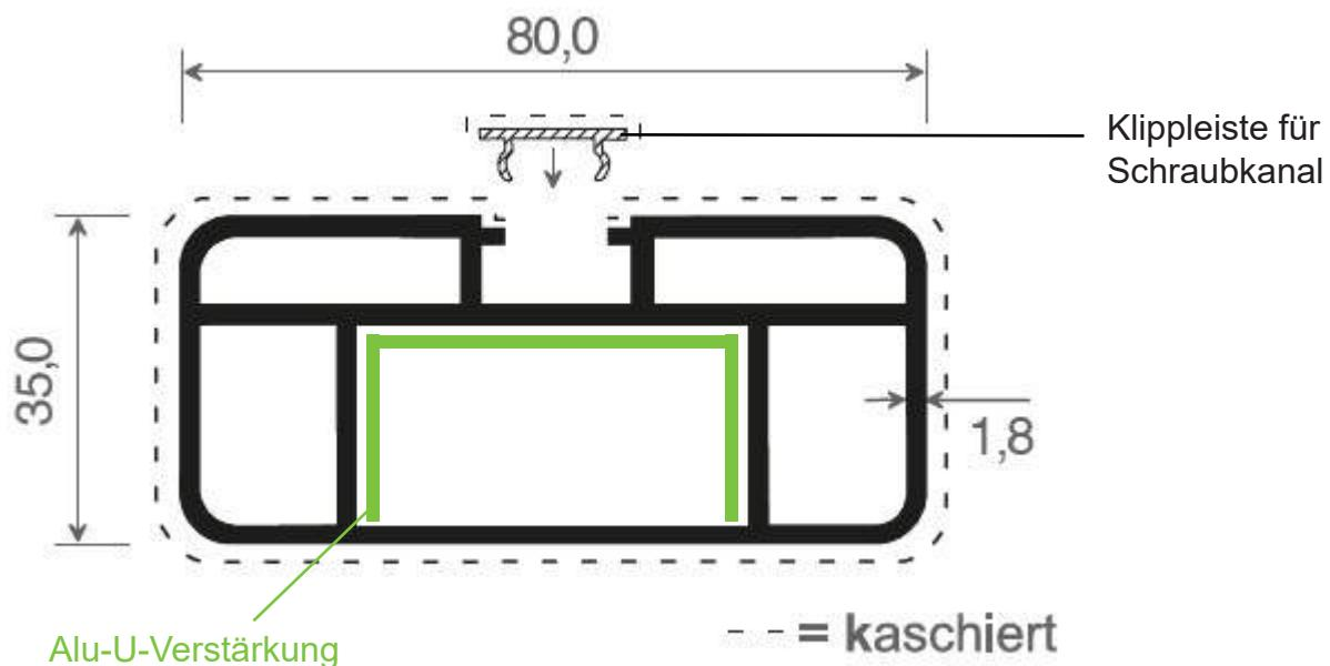
**1** Befestigung der Querriegel an der Balkonstütze sollte immer mit min. M6 Schlossschrauben erfolgen. Die Verschraubung erfolgt durch den Querriegel und durch das innere Alu-U-Profil.
