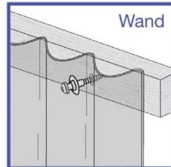
Vermeiden Sie zu starre Befestigungen. Schrauben nicht zu stark anziehen, nur bis zum ersten Widerstand. Nach ca. 3 Monaten, wenn sich die Unterkonstruktion gesetzt hat, müssen die Schrauben nachgezogen werden. Material nicht im Überlappungsbereich verschrauben.
