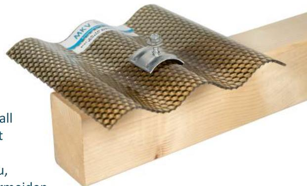
Unterstützungsabstände im Dachbereich: Lattenabstände max. 80 cm bei Acryl und max. 70 cm bei Polycarbonat.
