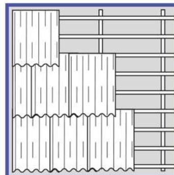
**Die Polycarbonatplatten müssen so verlegt werden, dass die Seite mit dem Aufkleber nach oben zeigt, da diese Seite oberflächenvergütet ist.**
