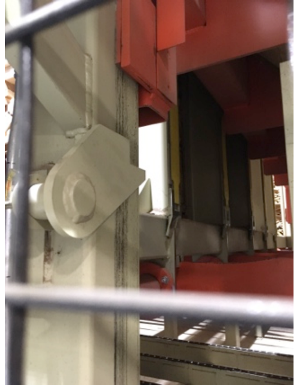
Stoppeur intégré à la structure sous les cases des classeurs
