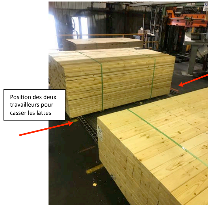
Photo 4 : Transfert des paquets vers le lève-paquet (lift) en vue de l'enveloppement
