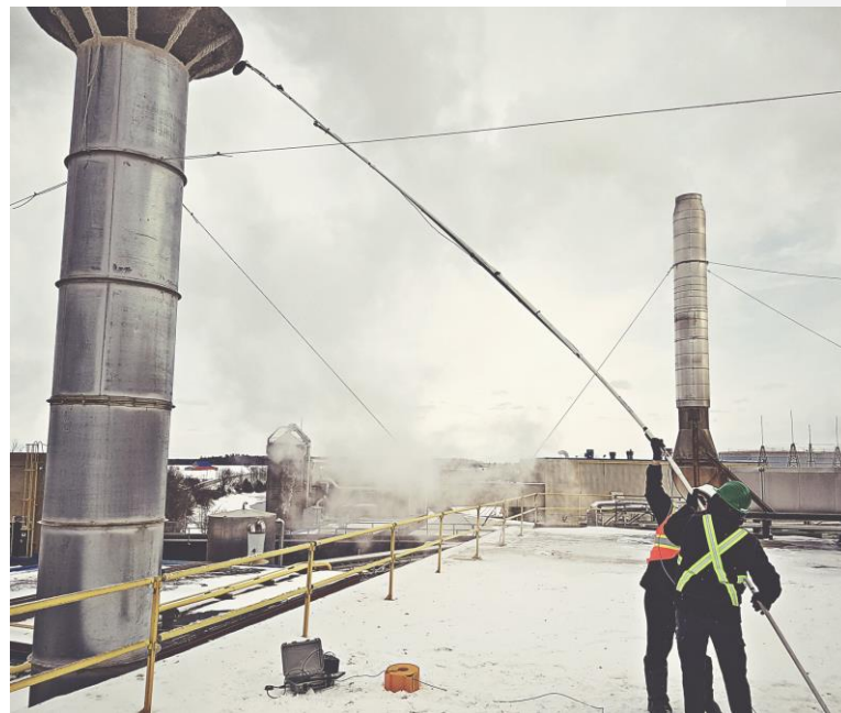
Mesures d'intensité sur une sortie d'air de cheminée
